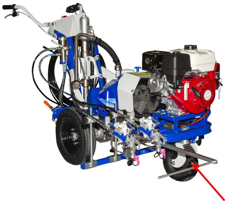
Traceuse autotractée à pompe hydraulique conçue pour le traçage de ligne routière. L'autotractage se fait grâce au pont hydraulique avec différentiel.
